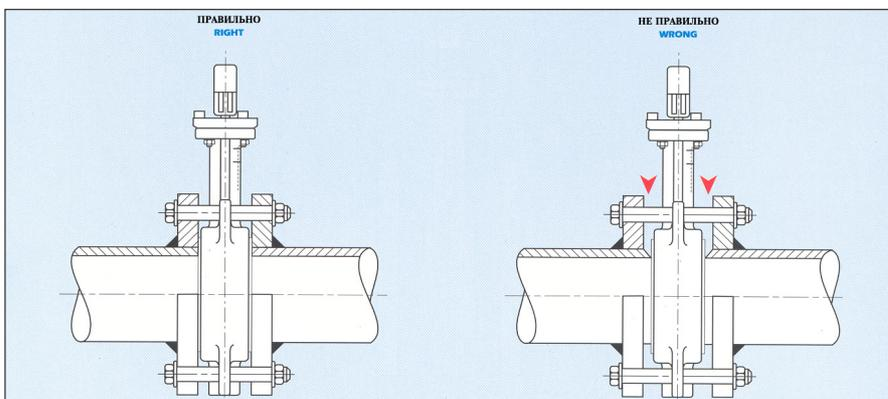
При установочных работах во избежание утечки, избегайте острых конечностей и металлических опилок на монтажной поверхности фланцев и труб, которые могут повредить прокладку дроссельной заслонки.
