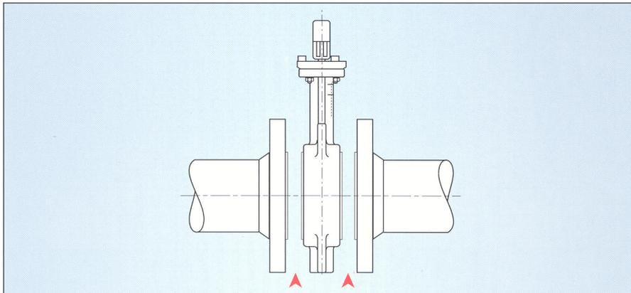
Во избежания деформации и повреждений поверхности дроссельной заслонки обратите внимание на наличие достаточного пространства между трубными фланцами.
