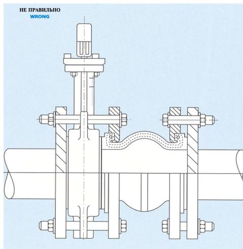
Резиновые поверхности прокладок заслонов и трубных фланцев категорически не должны приходиться друг на друга (как в гумовых компенсаторах). Идеальным герметичным соединением является стыковка резиновой прокладки на металлическую поверхность трубы или фланца.
