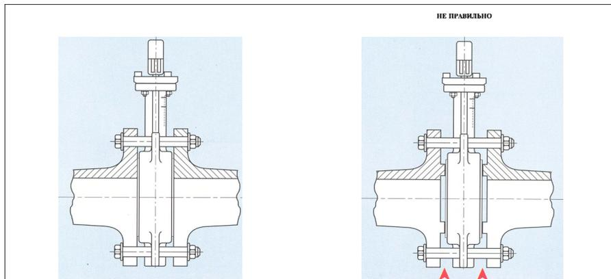
Для правильной инсталляции очень важен подбор подходящего соединительного фланца. Используемое фланцевое соединение должно охватывать максимальный диаметр посадки и седла дроссельной заслонки.
