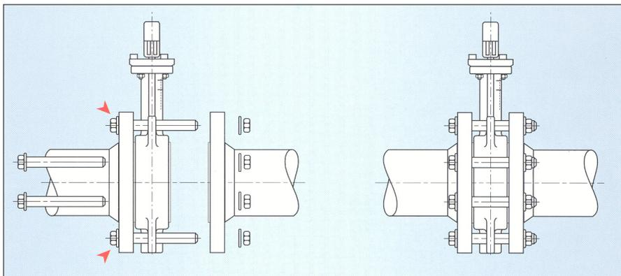
Не зажимая болты до конца зафиксируйте заслонку одним болтом к фланцам трубы. Затем центрируя ее ровно до полной посадки к трубным фланцам зажмите перпендикулярно болты до конца.
