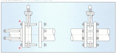
Не зажимая болты до конца зафиксируйте заслонку одним болтом к фланцам трубы. Затем центрируя ее ровно до полной подсадки к трубным фланцам зажмите перпендикулярно болты до конца.
