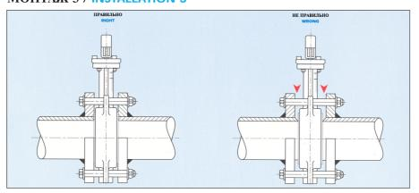
При установочных работах во избежание утечки, избегайте острых конечностей и металлических опилок на монтажной поверхности фланцев и труб, которые могут повредить прокладку дроссельной заслонки.
