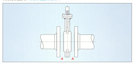
Во избежания деформации и повреждений поверхности дроссельной заслонки обратите внимание на наличие достаточного пространства между трубными фланцами. During installation to avoid the butterfly valve Mea surface inury and deformation leave sufficient installation space between pipe flanges.
