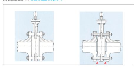
Для правильной инсталляции очень важен подбор подходящего соединительного фланца. Используемое фланцевое соединение должно охватывать максимальный диаметр подсадки и седалища дроссельной заслонки.
