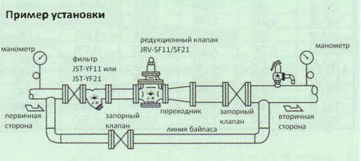
Давление гидростатических испытаний: JRV-SF11 – 15 бар;
