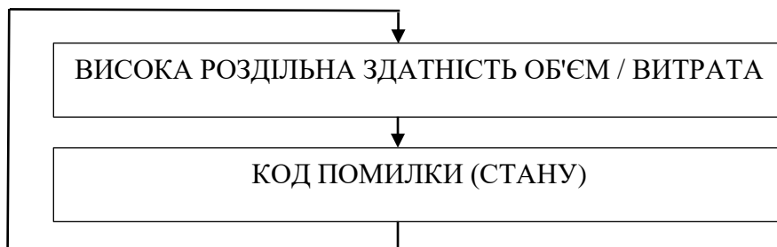
Мал. 6.2 Структура меню в режимі повірки (тестування)
